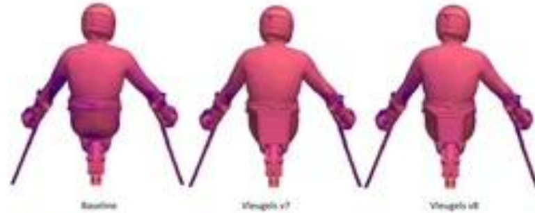
Aerodynamisch onderzoek paradi - ontwerpresultaat CFD simulaties
